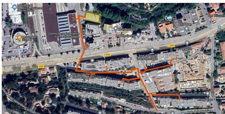
Le réseau alimente à ce jour principalement des habitations (Chauffage et ECS) construites en 2015. Le réseau actuel mesure 608 ml. Le réseau utilise l'eau comme caloporteur à basse pression.
